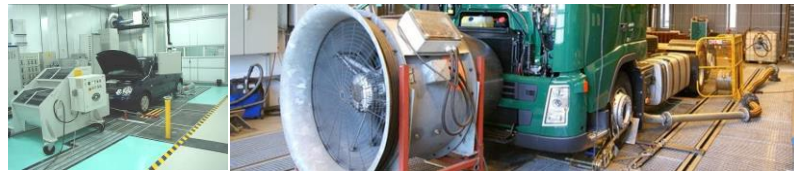
Ensayos de Vehículos Livianos y Pesados en Dinamómetro de Chassis
