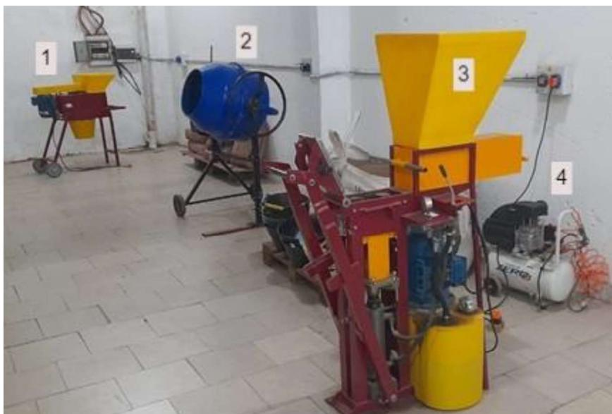
Figura 5. Maquinaria adquirida por la Cooperativa para la fabricación de BTC
