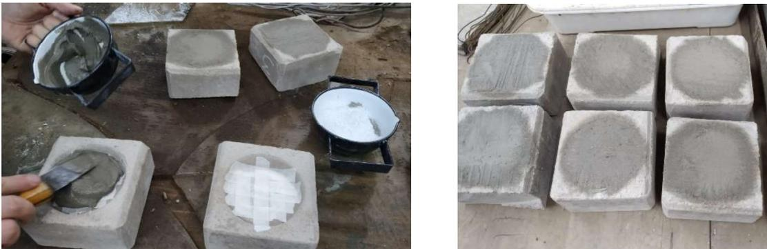
Figura 2. Relleno con mortero del encastre inferior de los medios BTC
