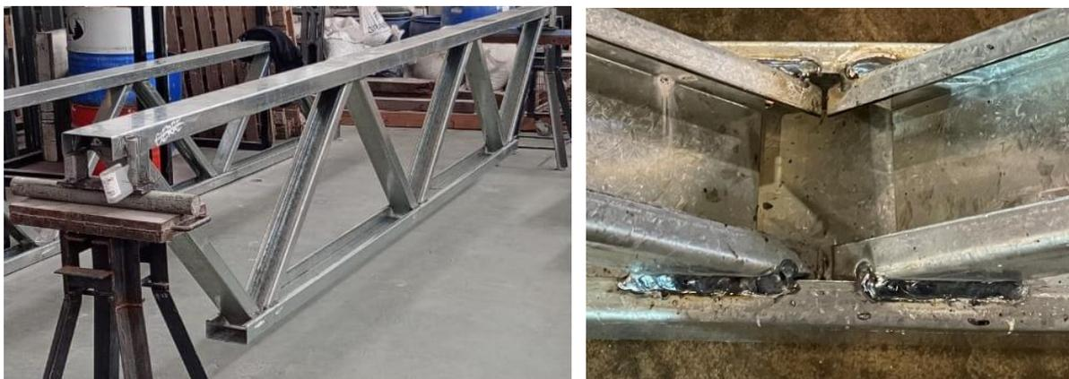
*Figura 11. Fotografía de vigas probetas y detalle soldadura de nudos*
