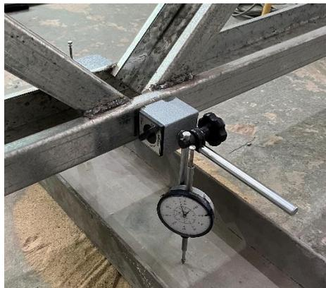
*Figura 10. Sección transversal ensayo. Ubicación dispositivos de medición.*
